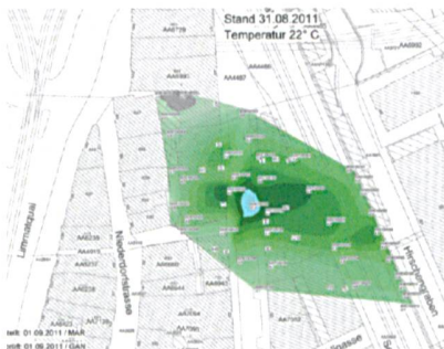
Durchmesserlinie Zürich: die Setzungsmulde nach dreimonatigem Stillstand der Tunnelbohrmaschine.
