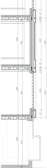
Links: Detail der südöstlichen Gebäudeecke: Die geschosshohen, vorfabrizierten Fassadenelemente aus Beton sind in Grösse, Form und Montage fein differenziert. Rechts: Konstruktionsschnitt durch die neue, wieder als Curtain Wall ausgebildete Fassade. Die vorfabrizierten Elemente aus Ultrahochleistungsbeton, die auf den ersten Blick massiv wirken, sind in Wirklichkeit dünn und relativ leicht.
