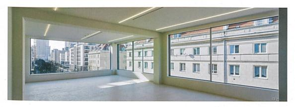
Ausstellungsebene im 3.0G: Die Betontragstruktur blieb erhalten und trägt die neue Fassade; die Heizung ist im neuen Anhydritboden integriert. Durch die grossen Fenster auf der Ost- und Südseite schweift der Blick in die ulica Górskiego mit ihrer neotraditionalistischen Architektur der 1940er- und 1950er-Jahre.
