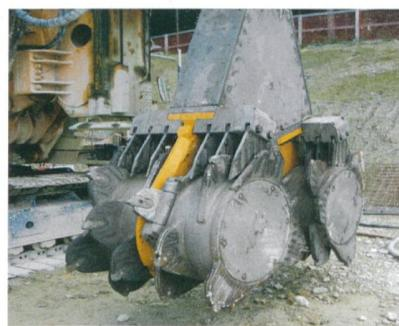
**Ostumfahrung Biel:** Mit diesem Fräskopf werden im Boden Elemente von  $1.0 \times 2.80$  m Größe hergestellt.
