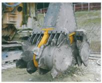
Ostumfahrung Biel: Mit diesem Fräskopf werden im Boden Elemente von 1.0×2.80 m Grösse hergestellt.
