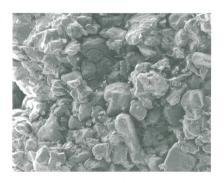
Biomineralisation: Elektronenmikroskopische Aufnahme des biozementierten Bodenmaterials mit 8.5% Kalzit. (Ausschnittbreite des Fotos: ca. 1.2 mm)
