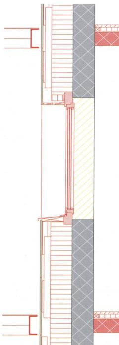
Die PV-Module heizen sich im Betrieb stark auf. Daher wird ein **Spezialvlies eingesetzt, das bis 120 °C hitzebeständig ist**. In der Ebene der Konterlattung befindet sich **der 60 mm breite Hinterlüftungsbereich**. Damit ist der Luftzug hinter den PV-Modulen gewährleistet, sie werden von hinten gekühlt. Bei Modulen auf Basis von kristallinem Silizium ist das für den Wirkungsgrad ein wesentlicher Faktor.
