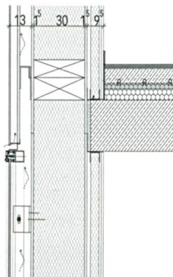
Die Module sind frei vor die Fassade gehängt, um eine ausreichende Hinterlüftung zu gewährleisten. Glas-Glas-PV-Module sind vierseitig umlaufend auf einem Alurahmen befestigt (oben und unten mit Halteleiste, an den Seiten jeweils mit zwei Rosetten zwischen zwei Modulen), dieser ist mit vier Haltewinkeln pro Modul an der Fassadenwand befestigt. Die Haltewinkel sind ins Holz geschraubt. Die Dämmung ist erst in der Holzwand montiert und wird von den Haltewinkeln nicht durchdrungen.
