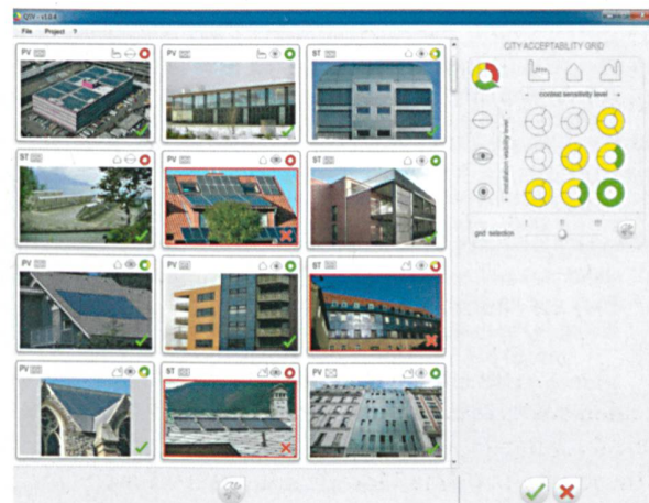
LESO-QSV Grid: Rechts oben ist die Matrix aus Sichtbarkeit der Anlage und Sensibilität der Bauzone. Die Mindestanforderung für die drei Teile des Doughnut-Diagramms (System-Geometrie, -Material und -Details) ist je nach Kontext höher (rot < gelb < grün). Links ist zu sehen, wie verschiedene Gebäude nach diesem System beurteilt wurden.
