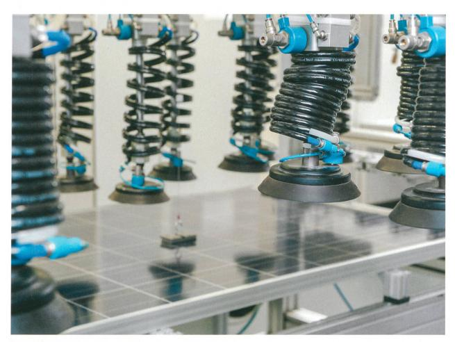
Nach dem **mechanischen Belastungstest der Photovoltaikmodule** werden Kontrollmessungen durchgeführt. Dazu gehören Sichtprüfung, Isolationsprüfung und Leistungsmessung sowie die Überprüfung der Elektrolumineszenz und Infrarotfotografie.
