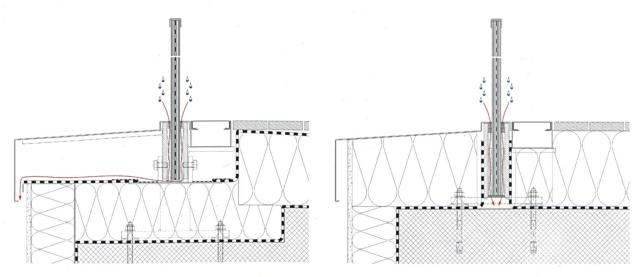
Rechts: integrale Montage, nicht sanierungsfähige Ausführung mit seitlich angeschlossener Abdichtung. Links: aufgesetzte Montage mittels abgeschotteter Konsolen, die oben einen Klebeflansch aufweisen. Über dem Klebeflansch wird die eigentliche Geländerkonstruktion aufgenommen. Hier ist nur ein Unternehmer für die Abdichtung zuständig.
