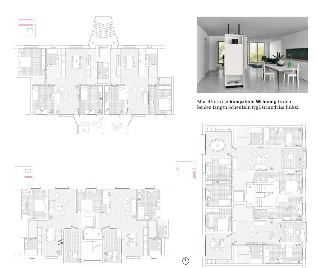
$F\"{u}r\ jeden\ Abschnitt\ der\ \ddot{U}berbauung\ haben\ Pool\ Architekten\ \textbf{eine}\ \textbf{eigene}\ \textbf{Typologie}\ angewendet.\ Grundrisse\ im\ Mst.\ 1:200.$
