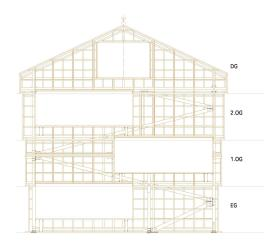
Die nördliche Giebelwand ist tragend und steift das Gebäude zusammen mit dem Kern aus. Weil die Wand grosse Fensteröffnungen aufweist, trägt das in die geschlossenen Flächen eingeschriebene Fachwerk die Lasten ab (vgl. Skizze S. 32).
