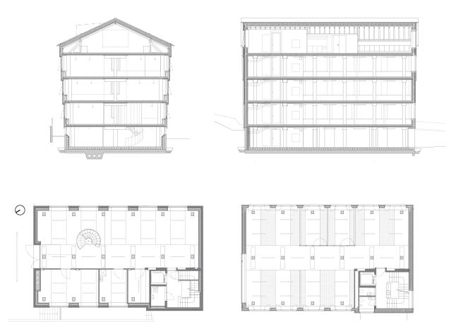
Quer- und Längsschnitt sowie Sockelgeschoss und 1. Obergeschoss. Im Dachquerschnitt zeigt sich ein fünfgelenkiges Druckpolygon aus Sparren, das durch die Aufdopplung in der Dämmebene ausgesteift wird. Die Pfosten werden bei symmetrischer Last zu «Nullstäben»; Mst. 1:300.
