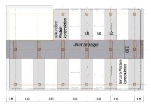
Die Deckenkonstruktion besteht aus einem linear angeordneten Tragwerk mit gelenkig untereinander zusammengefügten Brettsperrholzplatten. Ein zentraler, über sechs Stützen durchlaufender Primärträger bildet das Rückgrat. Daran angehängt sind die Sekundärträger, die punktuell auch auf den Randstützen liegen. Zwischen den Sekundärträgern sind die Tertiärträger mit Akustikeinlagen eingehängt.
