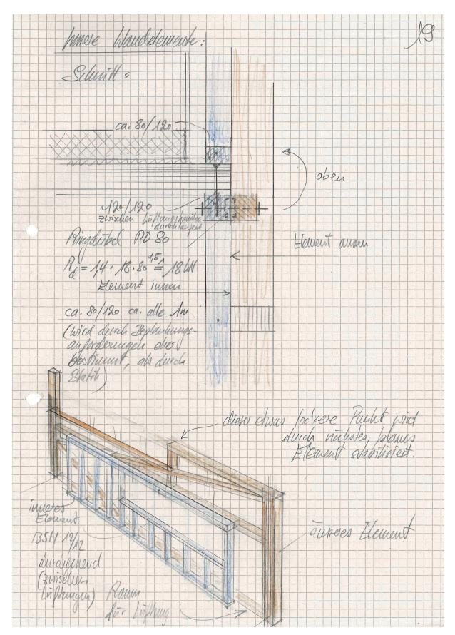
Die nördliche Giebelwand ist dreischichtig aufgebaut: Die horizontale und vertikale Lastabtragung sowie die Aufdopplung für die Fassadenkonstruktion sind getrennt. Die Konstruktion besticht durch ihre Dreischichtigkeit und damit die Dreidimensionalität.
