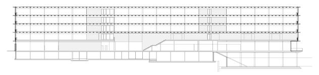
Im Schnitt ist der betonierte Sockel ersichtlich, auf dem der Holzbau steht. Längsschnitt im Mst. 1:750.
