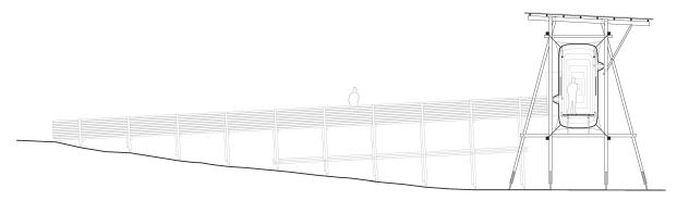
Querschnitt durch die Holzkonstruktion: Sie sollte so schlank wie möglich ausfallen, Schrauben verbinden die einzelnen Streben. Mst. 1:200.
