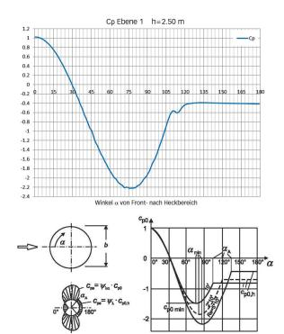
Die obere Grafik zeigt die berechneten Druckbeiwerte am Zylinderfuss der Radarstation. Darunter, als Vergleich mit den Normvorgaben, Bild 7.27 aus SN EN 1991-1-4 2005, das sehr ähnliche Beiwerte darstellt.
