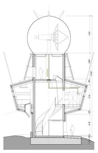
Zum Schutz vor Schnee- und Eisbefall sind alle Fassadenflächen angewinkelt. Der Hohlleiter ist so kurz wie möglich ausgeführt.
