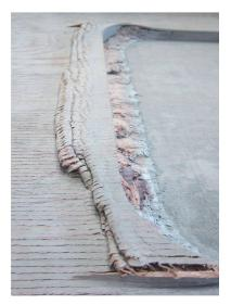
Damian Lüthi prüfte den Schubwiderstand von Taschenkerben in Holz-Beton-Verbunddecken aus Buchenholz. Die Prüfeinrichtung (ganz oben) leitet eine horizontale Kraft in das Holz ein, die wiederum in den Beton eingeleitet wird. Die Geometrie der Betontasche kann so gewählt werden, dass ein duktiles Holzdruckversagen (oben) eintritt, womit das gesamte Deckensystem gegenüber einen fragilen Bruchbild robuster wird.
