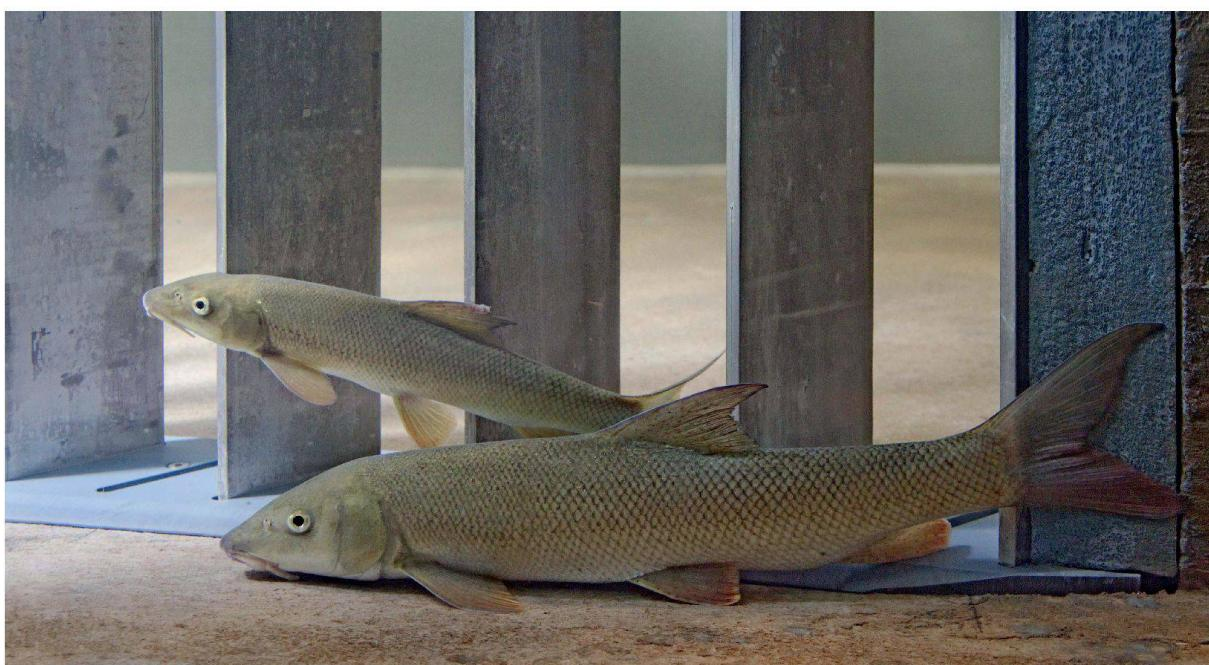
Ein Barbenpaar in der Versuchsanlage vor dem Leitrechen: **Die Fische lassen sich rückwärts die Strömung hinuntertreiben** und tasten mit der Schwanzflosse an den Stäben. Die Hauptströmung passiert den Rechen – das wäre der Weg durch die Turbine. Gleiten sie aber an den Stäben vorbei, finden sie den Einstieg in den Bypass.
