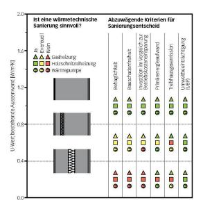
**Zusammenfassung der Erkenntnisse:** Ob bestehende Aussenwände mit U-Werten zwischen 0.4 W/m²K und 0.8 W/m²K zusätzlich zu dämmen sind, ist abhängig von der Gewichtung der Kriterien und muss fallspezifisch entschieden werden.
