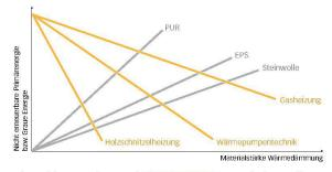
Abstrahiertes Schema: Die Primärenergie zur Beheizung eines Gebäudes sinkt, während die graue Energie des Dämmmaterials steigt. Wo sich beide Grössen schneiden, liegt die Grenzdicke der Wärmedämmung aus ökologischer Sicht.
