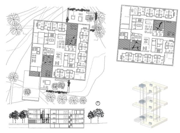
Die Grundrisse von EG und 1. OG zeigen, wie die **tief eingeschnittenen Höfe** Licht ins Haus bringen. In Schnitt und Schema ist ersichtlich, wie deren unterschiedliche Ausrichtung zusammenspielt. Alle Pläne, ausser Schema, im Mst. 1:800.
