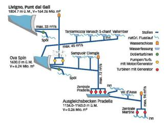
**Hydraulische Übersicht**: Der Livigno-Stausee ist der Kopfspeicher der Anlagen der EKW, mit einem nutzbaren Seevolumen von 164.26 Mio. m³.
