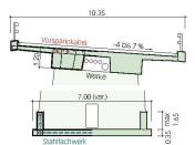
$1.\ Preis: \textbf{``Artg''}: Spitzbogen\ (l/f=5.9)\ in\ Stahl-Beton-Verbund bauweise\ mit\ aufgest" and erter,\ 13-feldriger\ Spann beton-Fahrbahn\ (l/h=13.5).$
