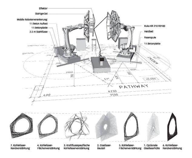
Auf den beiden Sechsachs-Industrierobotern werden anpass- und wiederverwendbaren Rahmen (Effektoren) montiert, die die Bauteilkanten des Elements festlegen. Die harzgetränkten Fasern werden spindelartig vom rechten zum linken Rahmen und umgekehrt gewickelt. Ein Bauelement besteht aus sieben Wickeletappen.
