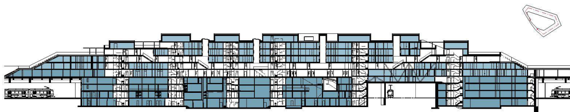
Der Schnitt durch das Gebäude (Mst. 1:1500) macht die Rue intérieure und die Lichtschächte sichtbar.
