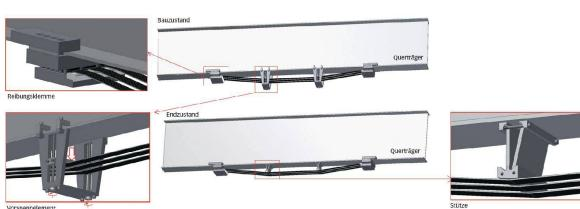
1. Preis: Aufgrund des Ermüdungsrisikos wird die Fachwerkbrücke über die Birs bei Münchenstein mit einer externen Vorspannung mittels Karbonfaserplatten verstärkt. Die Semesterarbeit ist Bestandteil eines Forschungsprojekts, das 2013 ausgeführt wurde.
