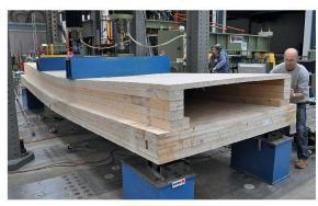
**Oben:** Visualisierung des achtschichtigen Berechnungsmodells. Die Verbindungen wurden mit Federn modelliert, deren Steifigkeit anhand von Materialversuchen an der Empa **(Abb. darunter)** kalibriert wurde.
