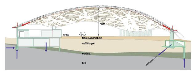
Im Managementbereich (links) werden die horizontalen Kräfte aus der Dachschale durch das eingeschossige Bauwerk in den Boden eingeleitet. Hangabwärts (rechts) werden die Lasten durch Pfähle und Litzenanker in die tieferen Felsschichten geführt.
