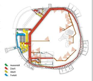
Lüftungsanlage im 1. UG, Grundriss
