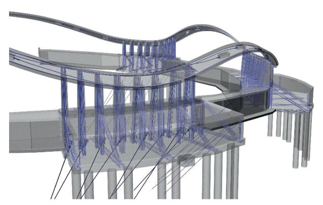
Am Rand der Holzschale ist ein **Ringbalken aus Spannbeton verborgen**, der das Dach wesentlich mitträgt. Die **neun einbetonierten Kabel sind bis zu 120 m lang** und mit einer Kraft von 189 t vorgespannt. Horizontalkräfte von bis 500 t pro Widerlager werden über Betonscheiben vor der Fassade im Boden eingeleitet. Die Verankerung im setzungsempfindlichen Boden erfolgt über Druckpfähle und Zuganker.
