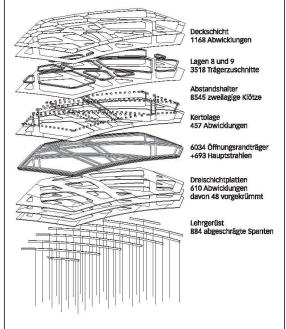
Übersicht der parametrisch erstellten Dachbauteile.
