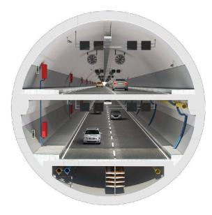
Autos und Minibusse von Asien nach Europa und umgekehrt werden künftig die beiden oberen Ebenen des Tunnels nutzen. Ganz unten befindet sich die Werkleitungsebene. **Der doppelstöckige Eurasia-Tunnel** ist mit den üblichen technischen Einrichtungen wie Beleuchtung, Ventilatoren, Funk und Video etc. ausgestattet. Zur Selbstrettung sind die Tunnelebenen auf der ganzen Länge regelmässig miteinander verbunden.
