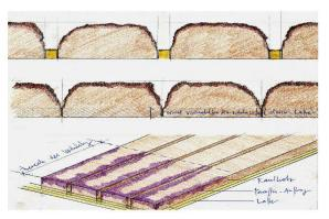
Flache Latten schützen den unteren Rand der Balken vor der Hitze. Zwischen den Balken entstand ein V-förmiger Hohlraum.
