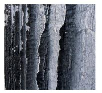
Drei Stufen: vom Flammen der Schalung über die verkohlte Oberfläche bis zum fertigen Element als Betonnegativ des Originals.
