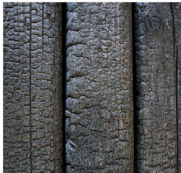
Drei Stufen: vom Flammen der Schalung über die verkohlte Oberfläche bis zum fertigen Element als Betonnegativ des Originals.
