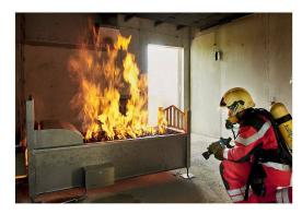
**Oben:** Aus dem Kontrollraum werden die Brände gesteuert und überwacht. **Unten:** Im neuen «Brandhaus II» hinterlassen die Gasflammen keine Spuren. In alten holzbefeuerten Brandhäusern entstand reichlich Russ, der sich an den Wänden ablagerte.
