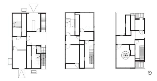
**Grundrisse EG, 2.0G, 4.0G**: Zwei Treppenhäuser erschliessen die oberen Stockwerke. Eines überwindet die Geschosshöhe mit zwei Läufen, das andere mit nur einem Lauf. Dadurch kann in beiden Arten von Aufgängen gleichzeitig und unabhängig voneinander der Brandfall geübt werden. Alle Massstäbe 1:250.
