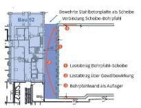
Oben: Situation Baugrube mit Nachbargebäuden aus den 1950er- und 1960er-Jahren. Unten links: Baugrubenschnitt auf der Westseite bei Bau 52. Unten rechts: Tragverhalten.
