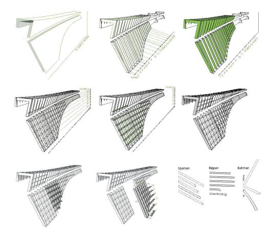
Die digitale Kette als Bindeglied zwischen Entwurf und Produktion: Die Prinzipien der Tragkonstruktion und der Bauteilverbindungen werden zuerst parametrisch festgelegt. Ausgehend von der gewünschten Oberflächengeometrie (oben links) werden automatisch die einzelnen Bauteile der Tragkonstruktion generiert, durchnummeriert und die Werkpläne für die Produktion erstellt (unten rechts).
