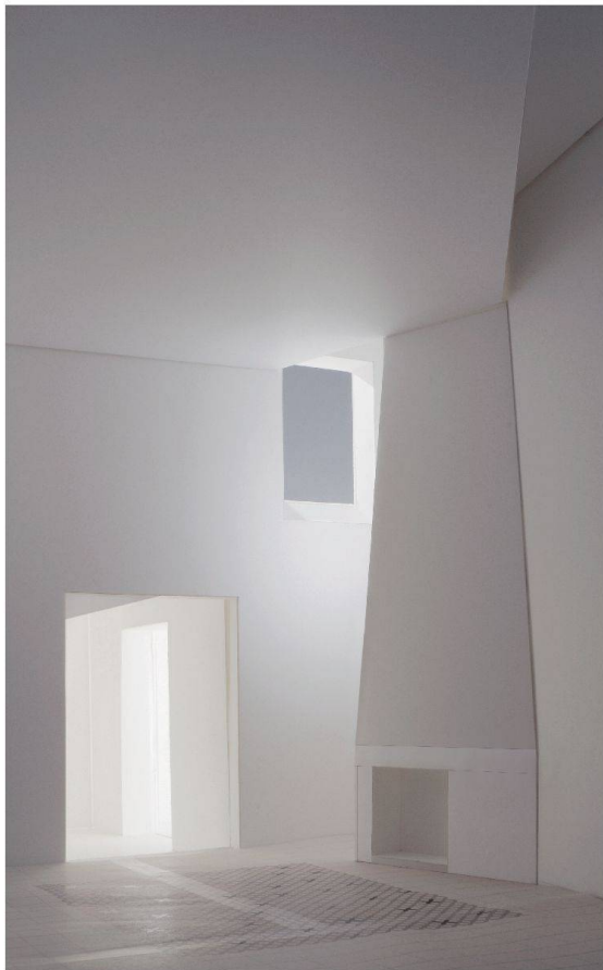
Arbeitsmodell für ein Haus in Cadaqués, Spanien. Das Architekturbüro Sergison Bates aus London und Zürich hat es von 2008 bis 2011 erstellt. Die Wirkung von komplexen Räumen lässt sich nur im analogen Modell adäquat untersuchen – insbesondere wenn das Licht eine entscheidende Rolle spielt.
