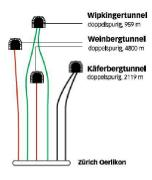
Rund 1 km vor dem Bahnhof Zürich Oerlikon enden die Tunnels, und die Gleise münden in den Bahneinschnitt. Um die zwei neuen Gleise (rot) aus dem Weinbergtunnel unterbringen zu können, wurde das Gleisfeld auf seiner ganzen Länge um bis zu 18 m verbreitert.
