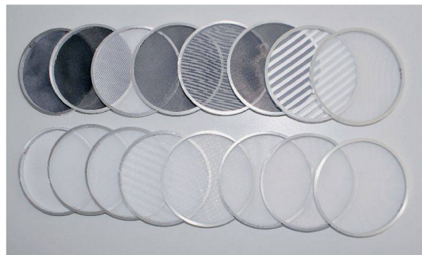
Oben: Das für die Messungen an der Empa verwendete Impedanzrohr (Funktionsweise siehe Kasten unten). Mit dem Griff im Vordergrund wird der Stempel verschoben, der den Hohlraum hinter dem Textil begrenzt. Oben auf dem Rohr sind die Mikrofone erkennbar. Unten: Für die Messung im Impedanzrohr vorbereitete Gewebeprototypen.
