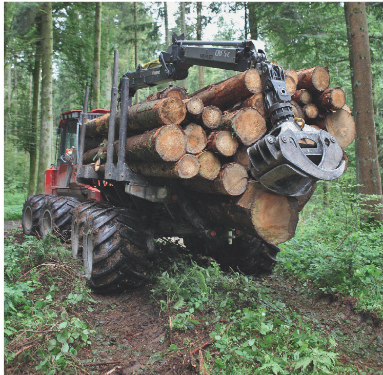
Beim Holztransport mit Rückfahrzeugen entstehen die grössten Belastungen.
