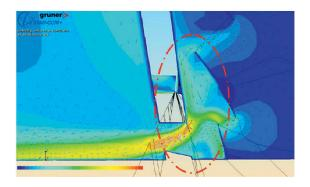
Die Nachströmöffnungen der Hallengeschosse befinden sich zu einem Grossteil hinter den nahezu geschlossenen Lamellen der Fassade (vgl. Abb. S. 83). Um ihre aerodynamische Wirksamkeit zu belegen, war ein Nachweis mit CFD (Computational Fluid Dynamics) nötig. Das Ergebnis: Die Lamellen schränken die aerodynamische Wirksamkeit ein, die Öffnungen mussten 10 % grösser ausgeführt werden.
