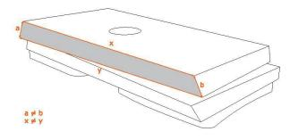
Das Gebäudevolumen besteht aus zueinander verdrehten Kanten. Die einzelne Fassadenfläche wird zum hyperbolischen Paraboloid. Die Fassadenkanten haben unterschiedliche Längen, für ein harmonisches Fugenbild wurden sie in gleiche n-Teile geteilt. Daher ist jedes Element einzigartig und kann nur eine einzige Position in der Fassade besetzen.
