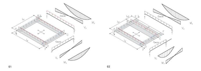
Die fiktiven Unterzüge leiten die Reaktionskräfte dann weiter zu den Punktlagern beziehungsweise zu den Stützen.
