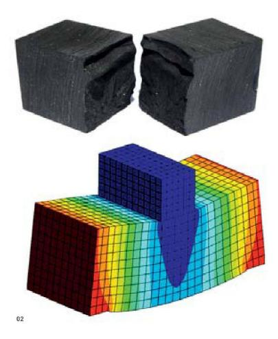
wie sich das potenziell geeignete Klebesystem auf Epoxidharzbasis über die angestrebte Lebensdauer hinweg näherungsweise verformt.
