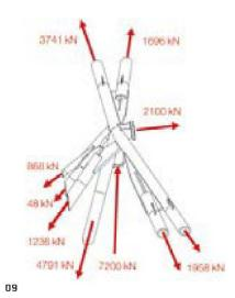
09 Die Rohrprofile des komplexen Knotens werden mit bis zu 7200 kN belastet. Die drei Hauptstäbe sind per Computer gefertigt und gesteckt, die restlichen Stäbe mit Laschen angeschweisst.
