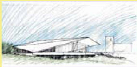
01 Die Skizze der Architekten zeigt die Absicht: Das Dach kragt weit aus und schwebt über einer filigranen Glasfassade. (Zeichnung: Richter·Dahl Rocha & Associés)
