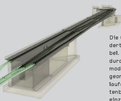
Die Geometrie der Oberwasserbrücke erforderte massive Bewehrungseisen und Spannkabel. Die begrenzten Platzverhältnisse konnten durch Überlagerung der einzelnen 3-D-Teilmodelle (Koordination Werkleitungen, Rohbaugeometrie und Bewehrung) sowie durch den laufenden Abgleich gelöst werden. Einzelknotenbetrachtungen sind mehrfach zwischen den einzelnen Planern ausgetauscht worden.
