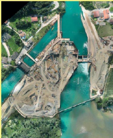
**01** Am bestehenden Hagneckkanal wurde das alte Wehr abgerissen; bis 2015 werden ein neues Wehr sowie ein neues Krafthaus mit zwei Turbinen für die Kraftgewinnung gebaut. Im alten Kraftwerk, das unter Denkmalschutz steht, bleibt nur eine Turbine von ehemals fünf in Betrieb. Weiter entstehen eine Bootstransportanlage zwischen Bielersee und Hagneckkanal sowie ein Umgehungsgerinne für den Fischaufstieg. (Foto: Bielerseekraftwerke AG)
