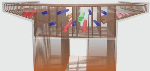
Die Brücke Oberwasser dient nicht nur der Erschließung des Kraftwerks, sondern ist gleichzeitig die Verbindung für die Energieableitung mit einer Vielzahl von Rohrleitungen.
