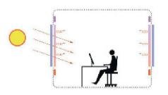
01 Sommer, Tag: Der regulierbare Sonnenschutz in der äusseren Schicht verschattet die sonnenbeschienene Seite entsprechend dem Bedarf. Auf der sonnenabgewandten Seite werden in der äusseren Schicht keine Partikel zugegeben und das maximale Tageslicht gelangt in den Innenraum. Über die raumseitige Schicht kann der Innenraum bei Bedarf gekühlt werden. Die Flächenkühlung sorgt für hohen Komfort. (Bilder: Universität Liechtenstein)
