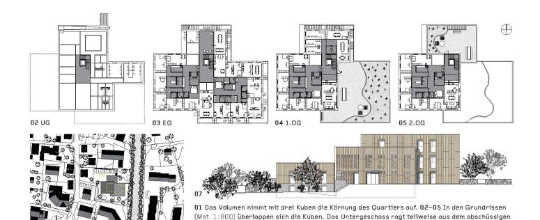
somit nicht infrage – die Klienten werden während der Bauphase in einem Provisorium untergebracht. Der Neubau sollte deshalb möglichst schnell errichtet werden können. Blättler Heinzer Architekten reagieren auf diese Anforderung mit einem betonierten Kern, der die sanitären Anlagen und die Erschliessung umfasst, umgeben von einem Kranz aus Holz mit den restlichen Zimmern. Diese Konstruktion verspricht einen schnel-
