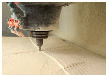
03 Erstellung des physikalischen Modells in der Fräse.
