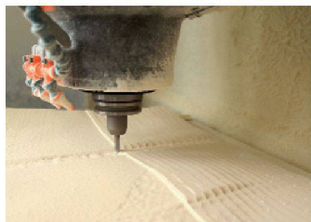
03 Erstellung des physikalischen Modells in der Fräse.
