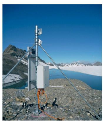
mehreren Niederschlagsstationen in einem Gebiet. Der Server gibt die Warnung an die zuständigen Experten in unterschiedlichen Gefahrenstufen (z.B. Vorwarnung, Hauptwarnung, Alarm) aus, die er anhand vorgegebener Grenzwerte berechnet. Die Experten führen dann detaillierte Analysen der verfügbaren Messdaten durch und bewerten diese mithilfe von Modellen. Bei Bedarf definieren sie indirekte Parameter neu als direkte Parameter und verkürzen die Messintervalle.
