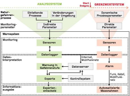
04 Übersicht über die Komponenten von Analyse- und Grenzwertsystemen, wobei die Art der Monitoringparameter den Systemtyp bestimmt. (Grafik: Autoren/Red.)
