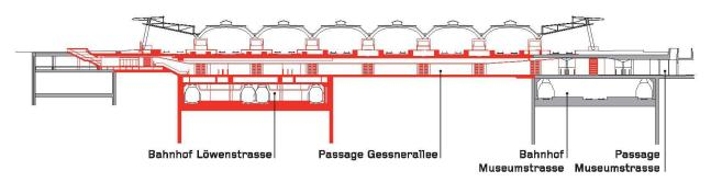
05 Hauptbahnhof Zürich, Querschnitt durch die neue Passage Gessnerallee (ohne Massstab). (Pläne: Dürig AG)
