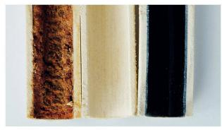
Heizungsrohr vor, während und nach der Sanierung.
