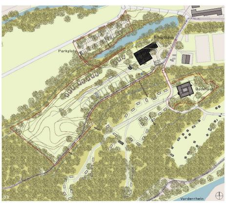
01-03 «Tuturna» (Huonder/Eugster/Bieler): Campingplatz auf vier Lichtungen im Auenwald des Vorderrheins. Haupthaus aus vorgefertigten Holz-bauelementen mit gebrannten Holzfassaden. Erdgeschoss, Mst. 1:2500. (Plan und Visualisierungen: Projektverfasser)
