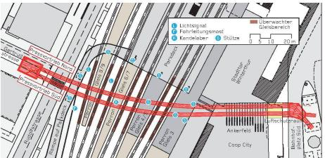
01 Mit zwei parallelen Vortrieben wurde der Abschnitt zwischen Gertrudstrasse und Bahnhofplatz Süd in Winterthur unterquert: Länge je ca. 130 m, Längsgefälle: 4 ‰, Radius Vortrieb Nord 140 m, Vortrieb Süd 190 m. (Plan: Gruner AG)
