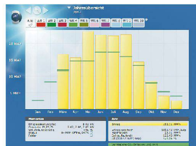
Links: Einfachstes Verkleben mit bis zu 25 Jahren Garantie. Rechts: Prognostizierte (grüne Striche) und tatsächliche (gelbe Balken) Stromproduktion 2012.
