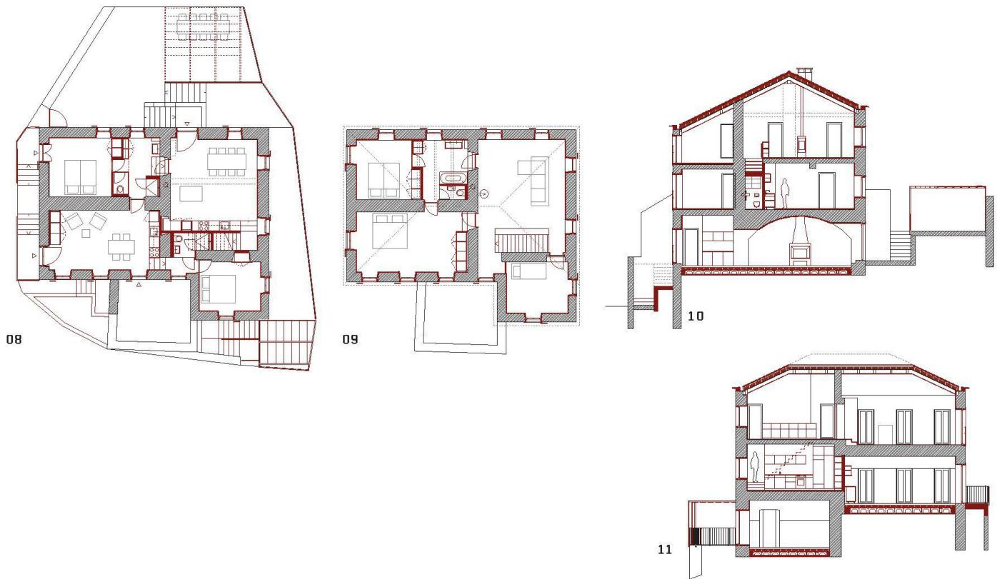
**08-09** Grundrisse Erdgeschoss und Obergeschoss. Die Interventionen durch Met Architektur sind rot eingezeichnet; Maßstab 1:300.
