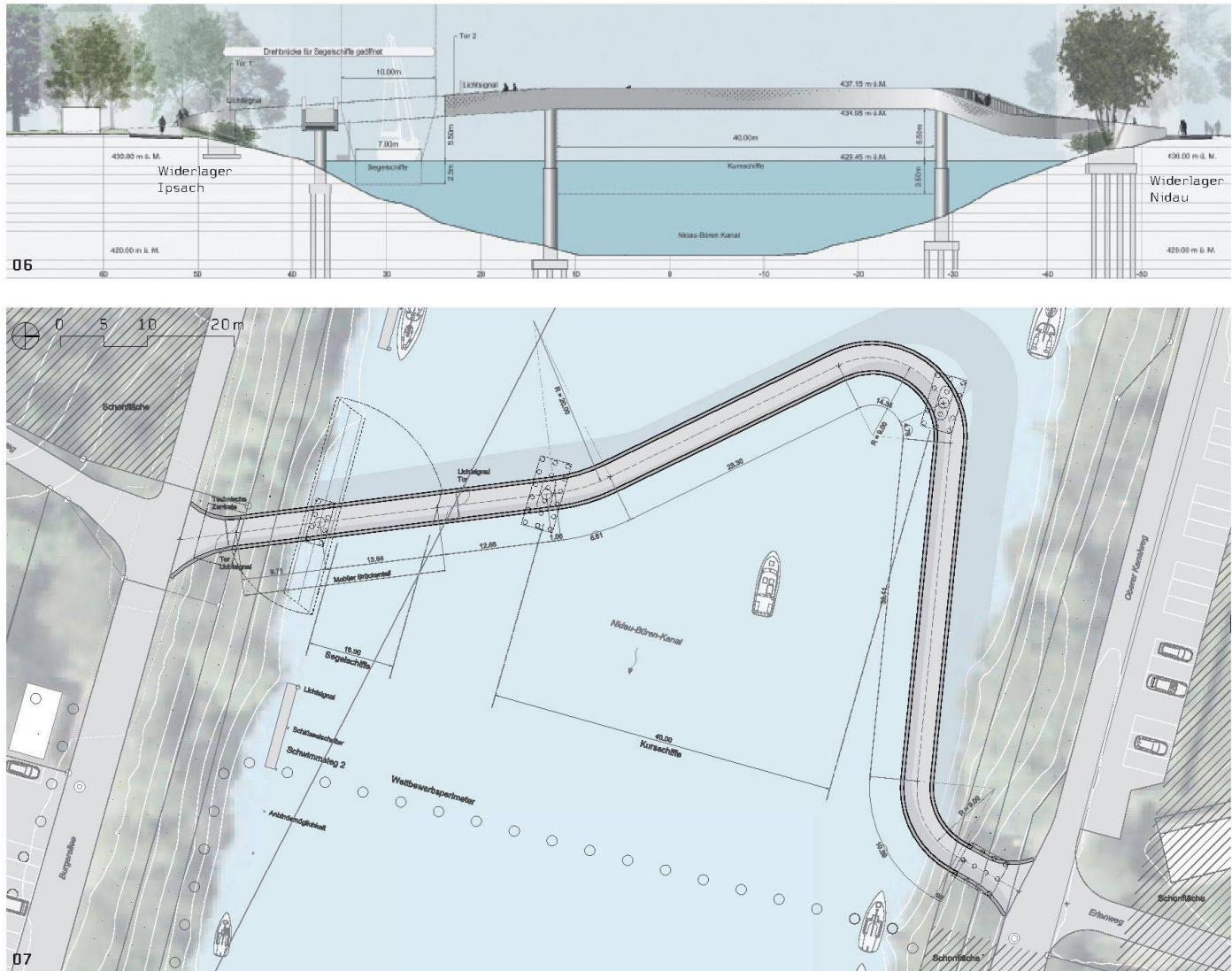
06–07 Siegerprojekt «Curva»: Ansicht mit geöffneter Drehbrücke. Grundriss im geschlossenen Zustand. (Pläne: Bächtold & Moor Ingenieure)
