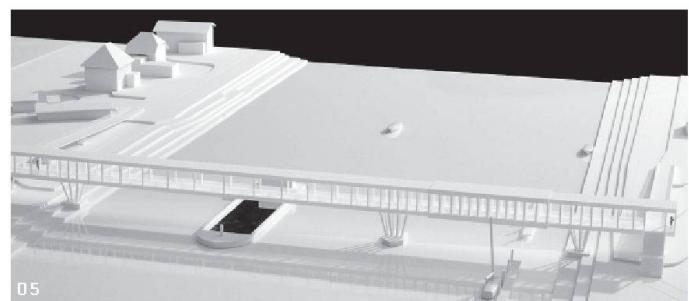
01–02 Siegerprojekt «Curva»: Die ungewöhnliche Form des 3.8 m breiten Stegs entsteht aus den Anschlüssen an die Umgebung, der maximalen Rampensteigung und der Durchfahrtshöhe für Kursschiffe – für Segelboote gibt es seitlich eine Drehbrücke.
