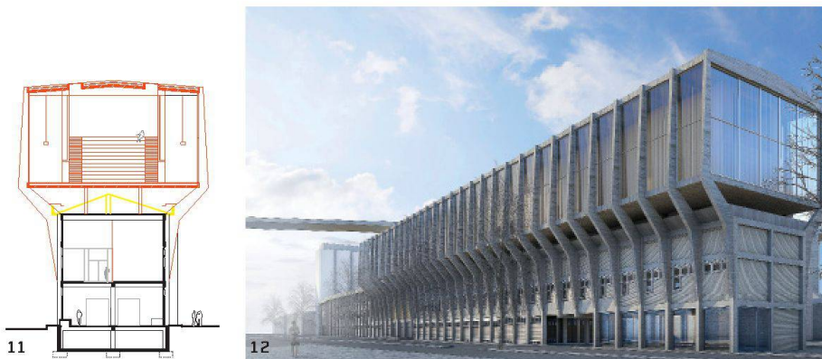
11–12 «Riuso/Trasformazione/Architettura»: Im ehemaligen Lissabonner Industriegebiet Poco do Bispo soll ein bestehendes Gebäude aus Sichtbetonrahmen und Backsteinausfachungen als Architekturschule umgenutzt werden. Im Bestand richten die Verfasser Studio- und Atelierräume ein, während eine auf der bestehenden Tragkonstruktion aufgebaute auskragende Aufstockung die Säle aufnimmt.
